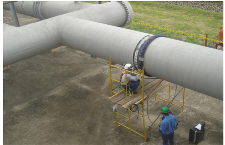
Inspección de un Dedo del *Slug Catcher* con un anillo inflable combinado de 48".
