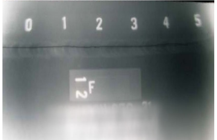
Radiografía de la soldadura con falta de penetración en la raíz, confirmada por la línea circunferencial oscura.
